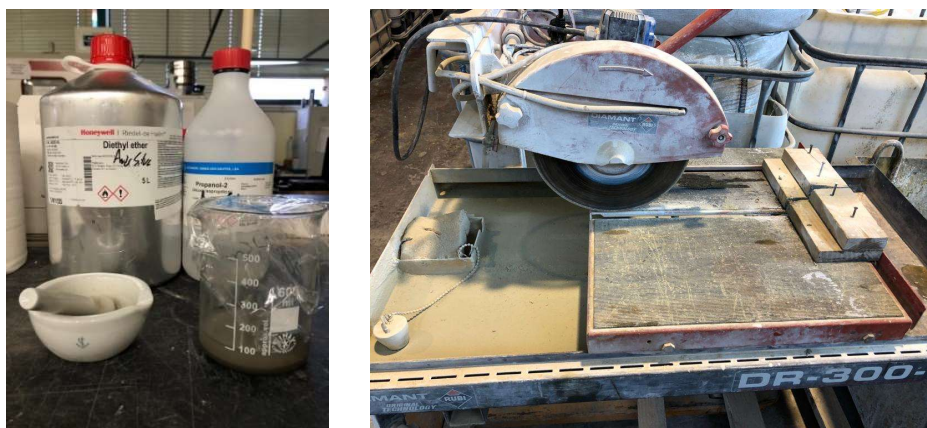
Figura 3.8 Materiais utilizados na paragem de hidratação (esquerda). Serra elétrica (direita).
