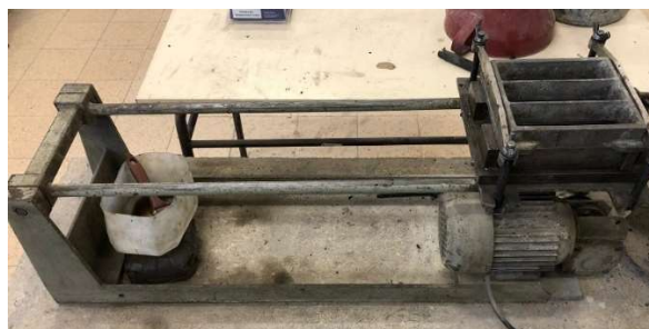
Figura 3.5 Mesa de compactação para a produção de pastas PCA.
