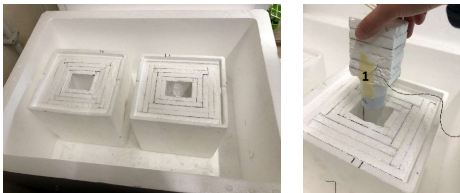
Figura 3.7 Equipamento utilizado em poliéster (esquerda) Colocação da amostra na caixa interior.
