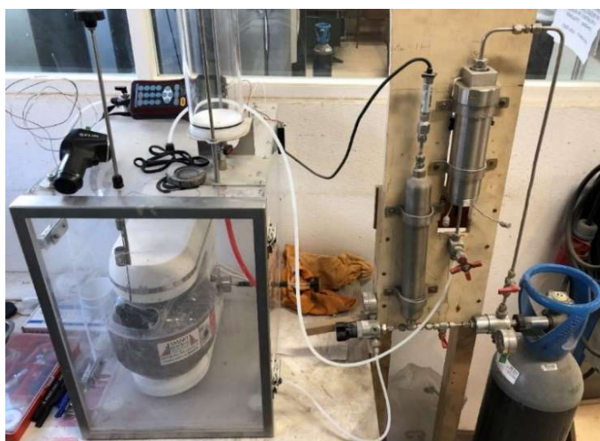
Figura 3.2 Sistema para a produção de pastas carbonatadas.
