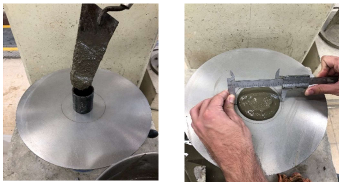
Figura 3.6 Ensaio de espalhamento para pastas PAC.
