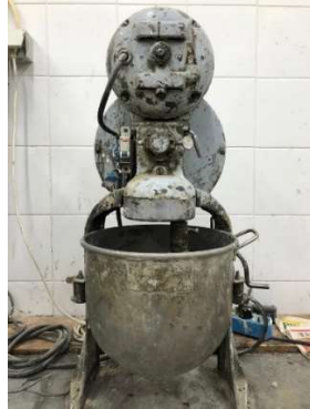
Figura 3.3 Misturadora para a produção de pastas não carbonatadas.
