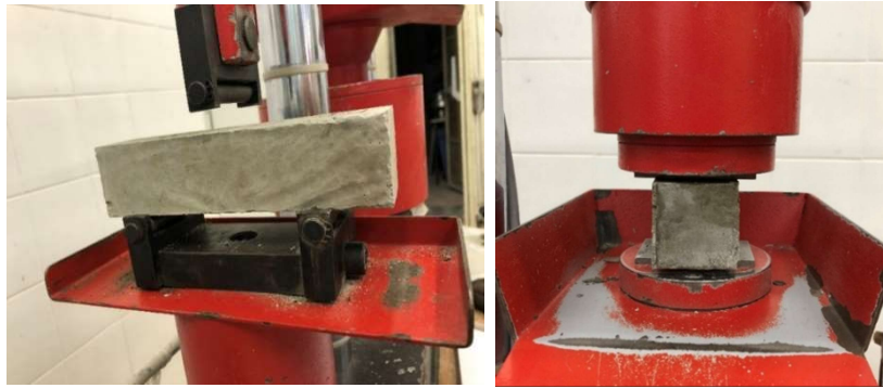
Figura 3.10 Rotura à flexão (esquerda) e Compressão (direita).
