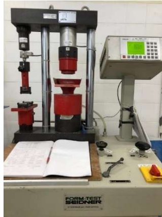
Figura 3.9 Prensa para o ensaio de caracterização mecânica.
